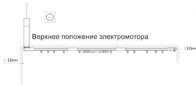
Одиночная установка электрокарниза
